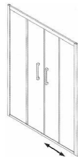
二固二活屏风推拉门 非标范围 Custom-made range W:1500-2000mm H:1900-2200mm
